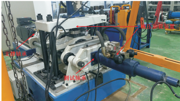
图 6 高速列车轴承综合试验台 Fig. 6 Wheelset bearing comprehensive test rig of high-speed train
